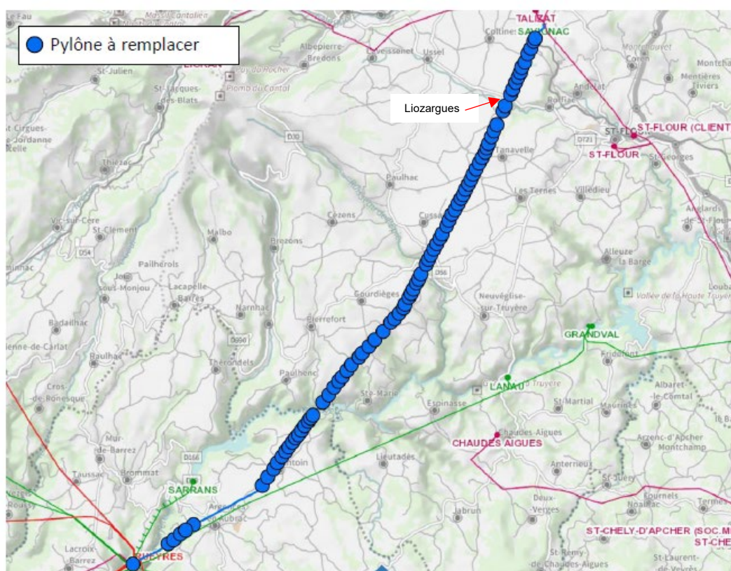
Figure 2 : Pylônes à remplacer (source : dossier)
